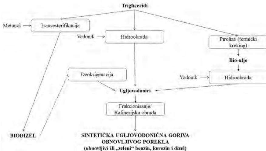
Slika 3. Mogući putevi konverzije sirovina na bazi triglicerida do tečnih biogoriva
