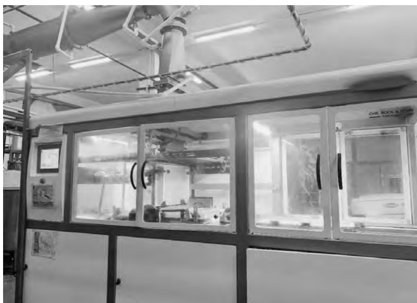
Slika 1. Mašina za pakovanje margarina za lisnato testo Figure 1. Packaging machine for puff pastry margarine
